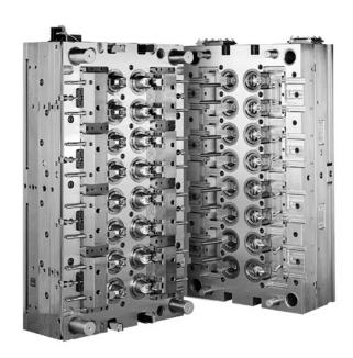
RoyAlloyは多くの金型メーカーや金型ユーザーで使用されています。RoyAlloyは、AISI 420F (JIS 420F) /W.Nr.1.2085タイプの鋼材に比べて、機械加工性、寸法安定性、表面仕上げ性に優れています。
