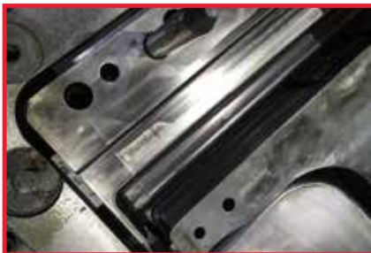
无涂层AISI D2 W.-Nr. 1.2379有明显磨损。
