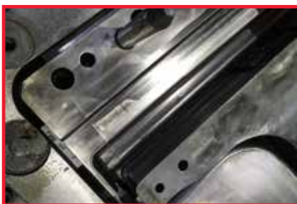
AISI D2/ W.-Nr. 1.2379コーティングなし。摩耗痕が認められる。
