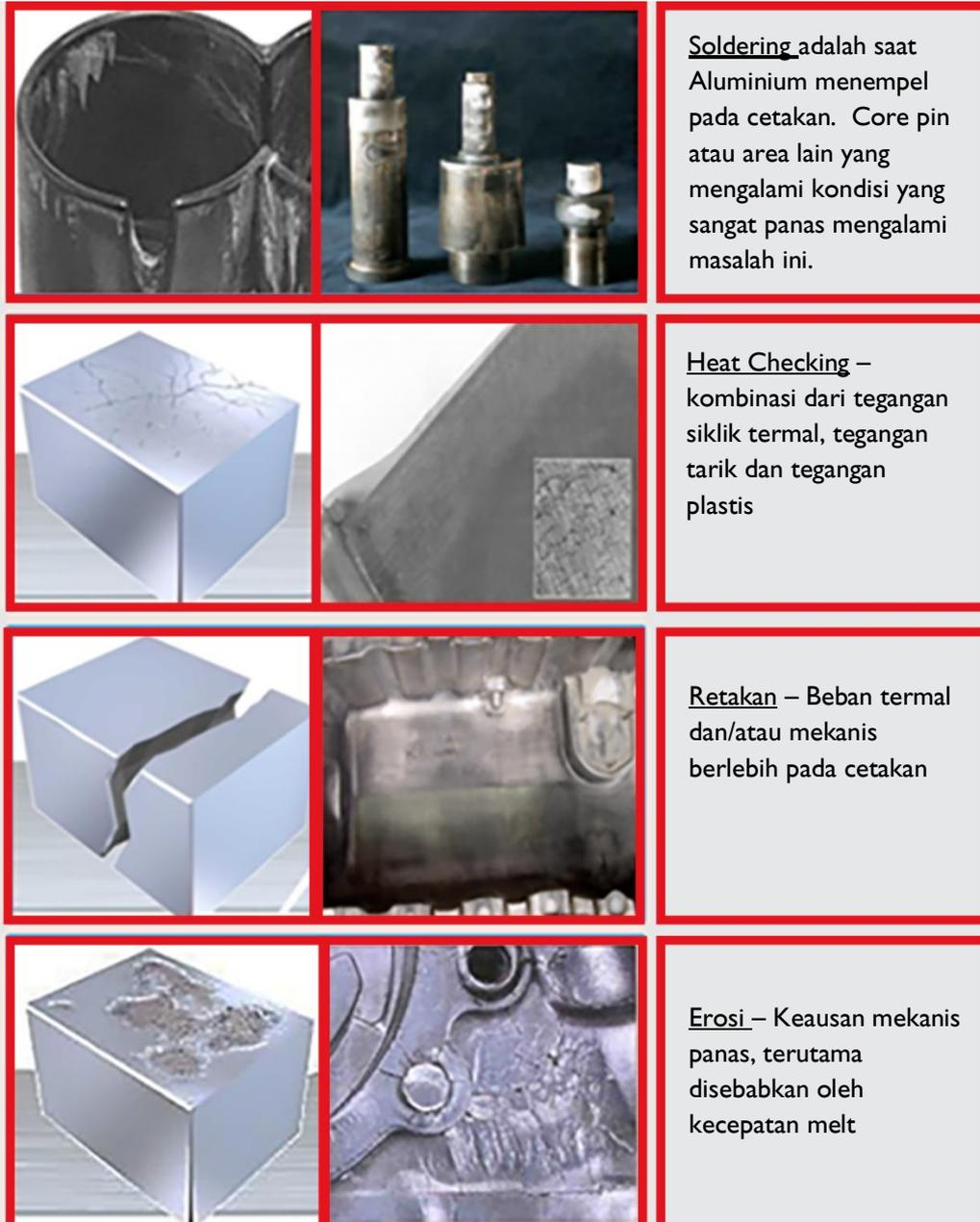
Soldering adalah saat Aluminium menempel pada cetakan. Core pin atau area lain yang mengalami kondisi yang sangat panas mengalami masalah ini.
