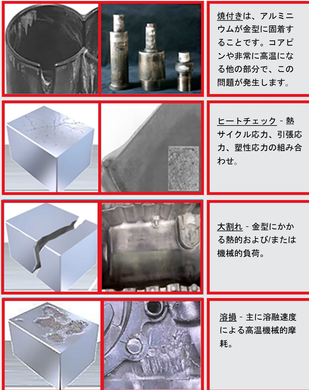
図 2 は HPDC の最も一般的な破損機構を示しています。
