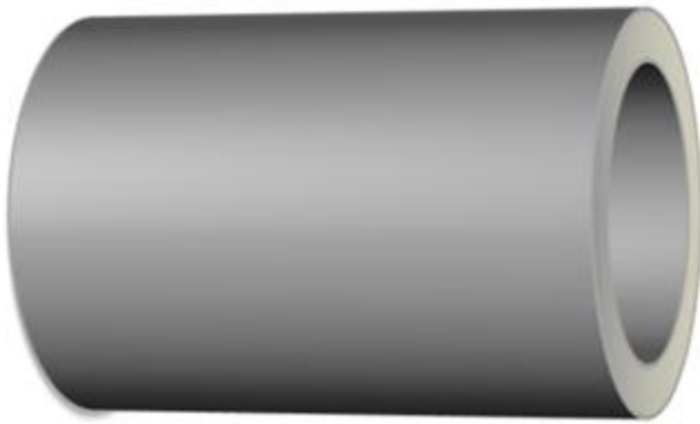
圖 3 顯示了熱疲勞試樣的幾何形狀
