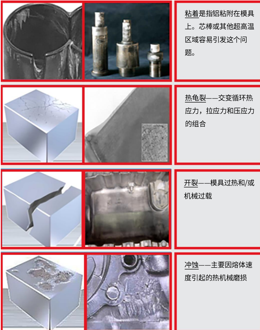
图 2 显示了 HPDC 中最常见的失效机制
