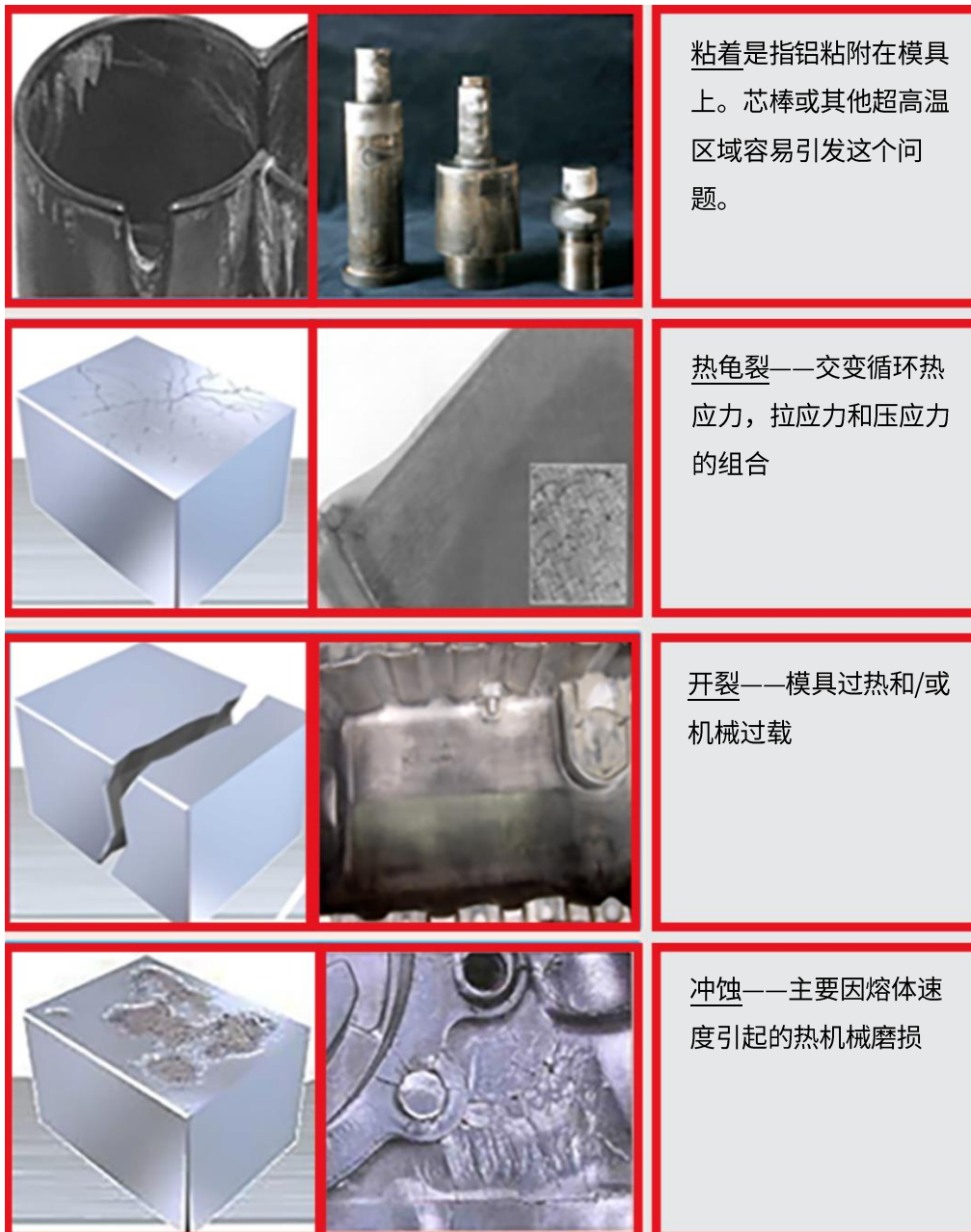
图 2 显示了 HPDC 中最常见的失效机制
