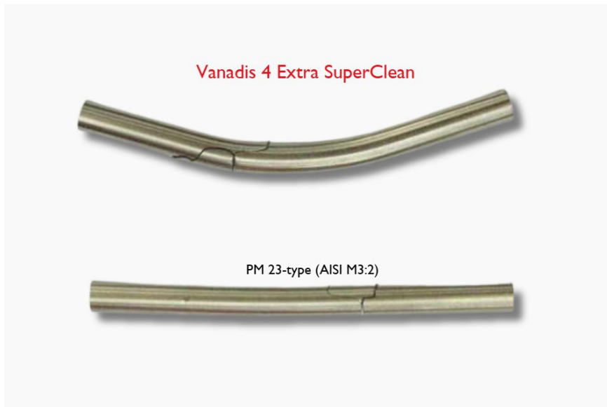
Hình 1. So sánh thử nghiệm uốn 4 điểm với loại PM 23, độ cứng 60-62 HRC.
