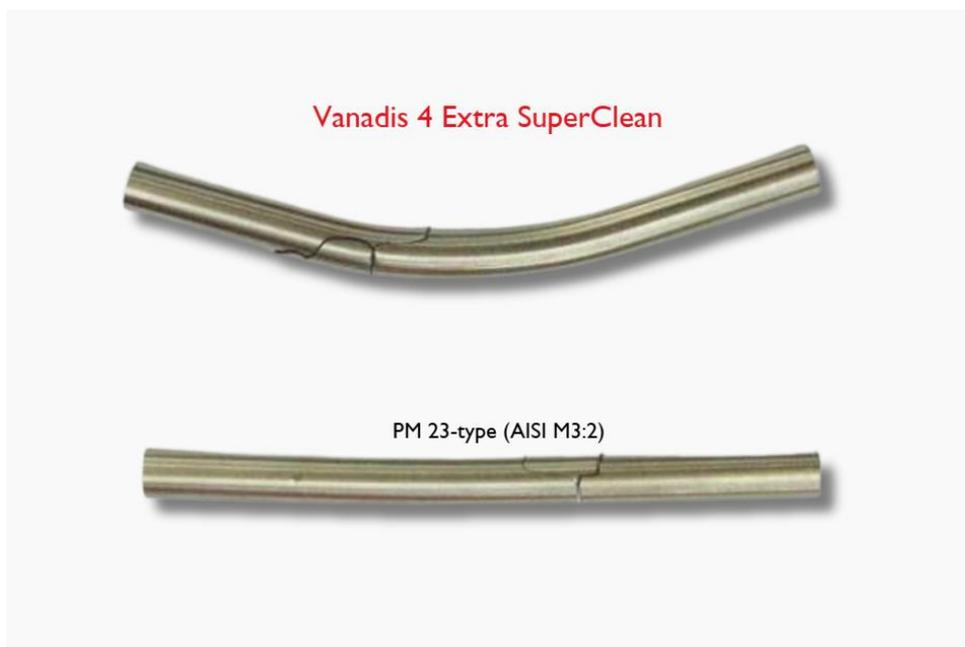
Gambar 4. Perbandingan uji tekuk empat titik dengan tipe PM 23, 60-62 HRC
