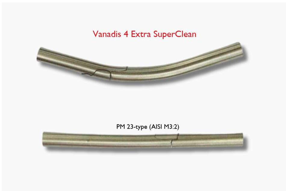
그림 1. PM 23-type, 60-62 HRC 와 4 점 굽힘 테스트 비교
