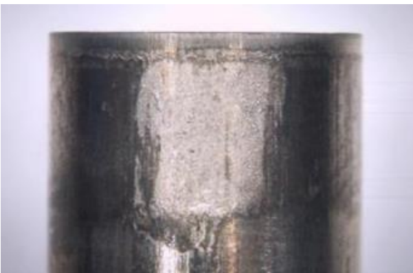
图 7. 冲压冲头发生严重的冷焊
