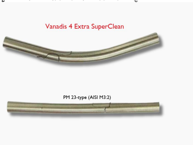
ภาพที่ 4. การเปรียบเทียบการทดสอบสีจุดในการงอกับเหล็กกล้า PM 23 ชนิด 60-62 HRC
