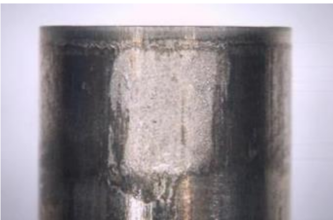
ภาพที่ 7. แม่พิมพ์บีมที่เกิดปัญหาการเสียดสีรุนแรง
