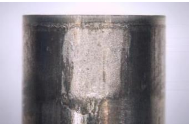
圖 7. 沖壓沖頭出現嚴重的拉毛磨損
