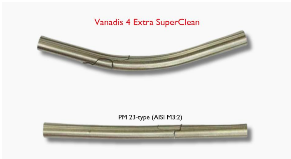
圖 4. 四點彎曲試驗與 PM 23 型 (60-62 HRC) 的對比
